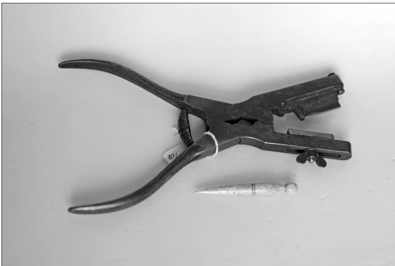
Fig. 6. Knaphulstang og pren er specialværktøj, som bruges ved professionel knaphulssyning. Se fremgangsmåde på næste side. Foto: Holger Agerskov.
