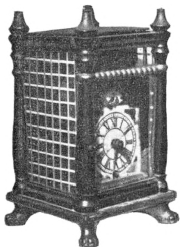
Uhr med Slagværk, lavet af N. Kragelund. Herning Museum. Pendulen, der sidder over Værket, roterer i en Fjeder, men Uhret gaar ved en Lod. Alt Værk, Skive, Viser og Kassen, er lavet af Niels Kragelund. Højde 25 cm.
