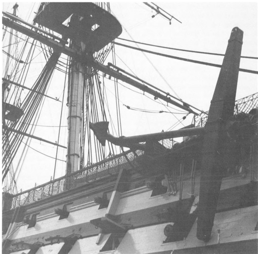
Linieskibet Victories styrbords side. Pligtankeret er placeret ved fokkemastens røst. Langs lønningen ses sinkenettet, hvori sømændenes hængekøjer blev stuvet under kamp. Victory var bevæbnet med 102 kanoner, og skibet var kun nogle få fod længere end St. George. (Foto: P. U. Jepsen, Portsmouth 1984).
