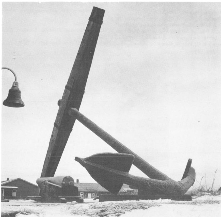
Sværanker fra St. George. Ankeret blev hævet i 1972 og står nu ved slusen i Thorsminde. Ankerets længde er 5,94 meter, og det vejer uden stok godt 4 tons. (Foto: P. U. Jepsen).
