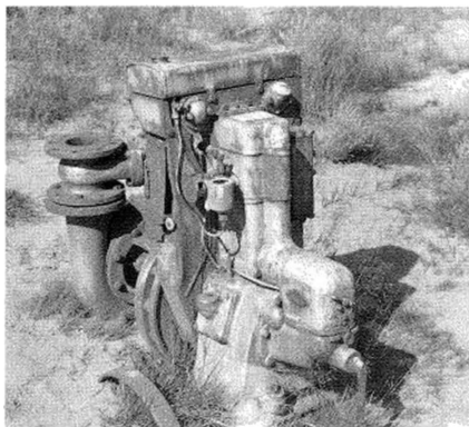
Reservepumpe trukket af petroleumsmotor. Brugt når strømmen svigtede og de normalt ældre pumper derfor stoppede. Ved Brunkulsmuseet.
