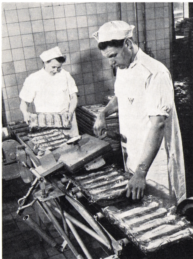
Maskine til pakning og varmelukning af cellofan-forbrugerpakninger udviklet i Esbjerg 1958.
