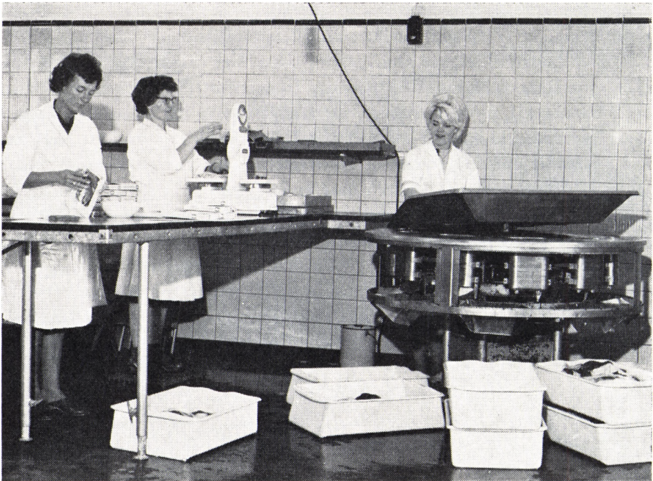
Maskinel vægtsortering og pakning af rødspættefileter på ny filetfabrik; bemærk anvendelsen af hygiejniske materialer overalt.
