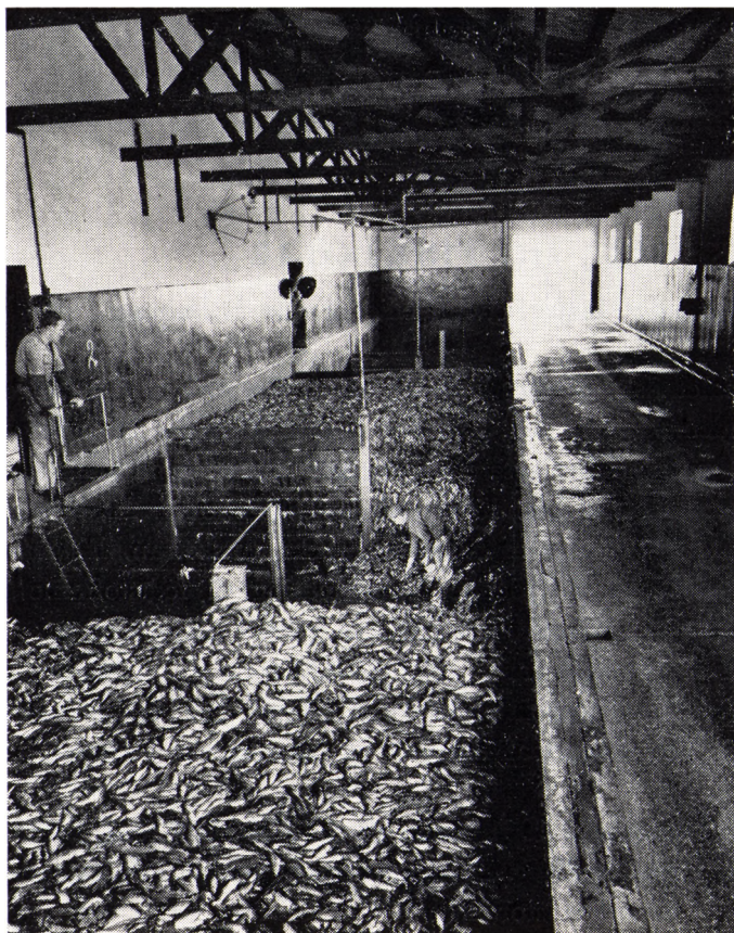
Fig. 1. Den almindelige form for råfiskbeholdere, hvorfra fisken ved hjælp af transportsnegle føres til fabrikation.
