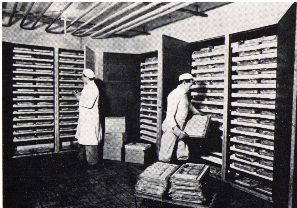
Såkaldt reolfryser, bygget i begyndelsen af halvtredserne. Der fryses såvel poundspakninger som 5 lbs. kartoner.
