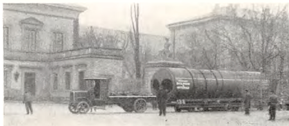
Transport af en 130 m 3 Lancashire-Kedel. Vægt 32 Tons.
