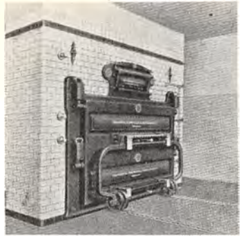
Moderne Vandrørsovn for store Bagerier og Brødfabrikker.
