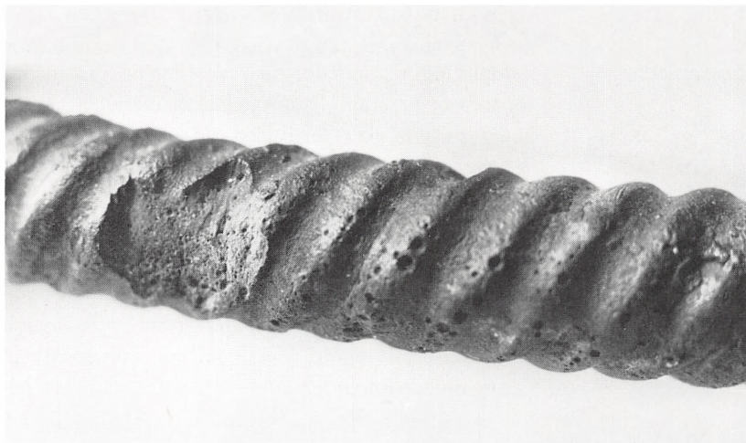
Fig. 10. Støbefejl på den hulstøbte ring, halsring 2. Små blærehuller i bronzen efter gasudvikling i den indre lerkjerne. Det store hul er en moderne beskadigelse, hvorved ringens lerkerne er blotlagt.
