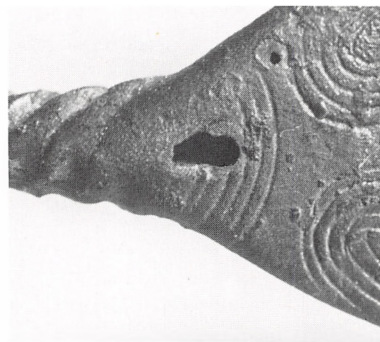
Fig. 9. Støbefejl på halsring 1. En såkaldt gasblæsning i den tykke overgang mellem plade og ring.
