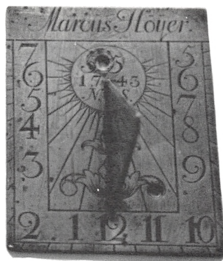
Fig. 2. Solor af messing. Polos er her fornet som en trekantet plade. Øverst graveret Marcus Høyer 1743.
