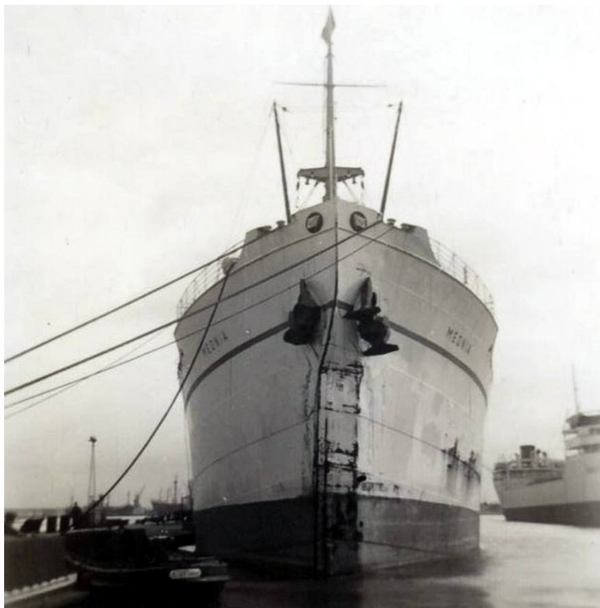
Meonia ved kaj med beskadiget stæv.
