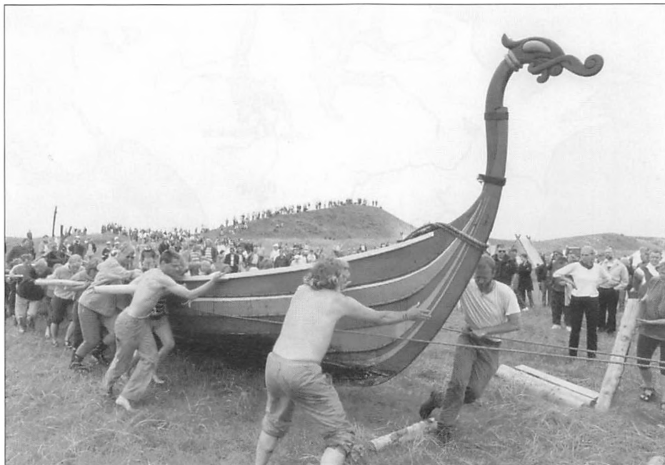
Fig. 2) Besætningen på "Helge Ask", en kopi af det lille krigsskib "Skuldelev 5", slæber skibet over draget ved Helgenæs for at afprøve denne form for landværts transport. Skibet er dog også forspændt fire islændere (små heste). Forsøget fandt sted i 1996. Helgelaugets fotosamling.
