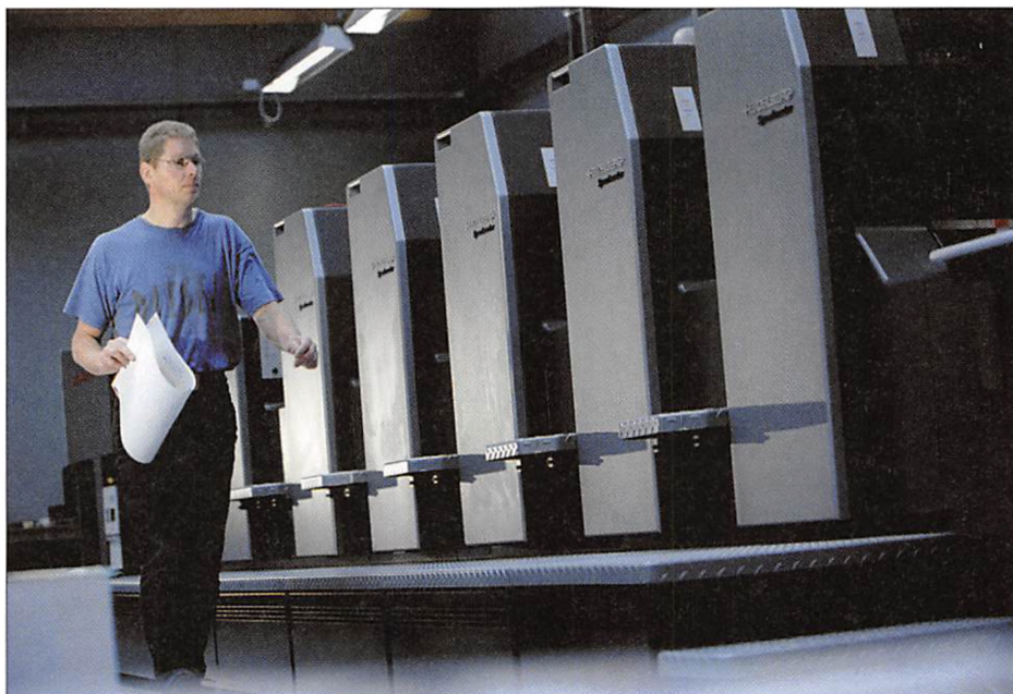
Moderne flerfarve offsettrykmaskine (Heidelberg SM74, 5 farver + vandlak) hos Jannerup Offset A/S, Slagelse.
