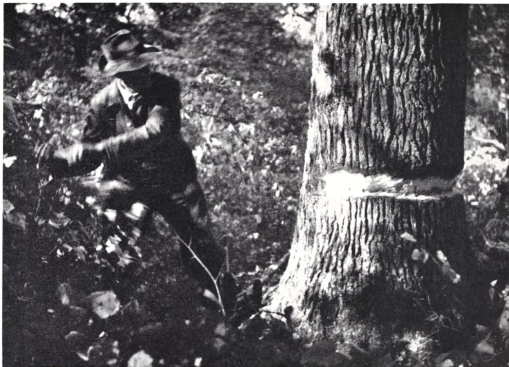
Fig. 26. Nr. 856. Eg (ringet), Diameter 73,2 cm. — Tid: 1 Time 30 Minutter. Huggets Begyndelse.
