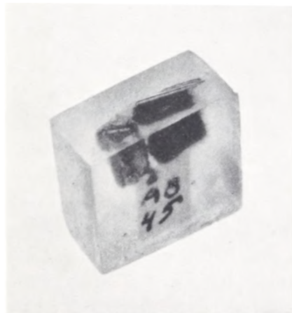
Fig. 10. Farvesnit indstøbt i klar plastic. Terningen er tilslebet, så farvesnittet ligger tæt under overfladen, hvorved det er muligt at iagttage det i mikroskop.
