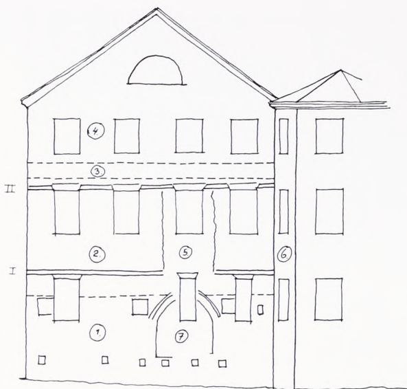
Fig. 4. Registrering af nordfacadens murværk:
