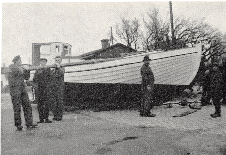
Transport fra værksted til havn af fiskebåd »Gerda« af Askø før søsætningen 1937. Over båden er lagt en bundgarnspæl, surret til røstjernene, rækkende ud til styrbords side og støttet af tre mand for at holde den i balance. Båden trækkes over træstykker, smurt med grøn sæbe (»udskør«, »fedtlapper«). Under forstævnen ses taljeblokken. Søsætningen skete med motoren installeret; samme dag kunne »Gerda« sejle hjem til Askø. — Fot. fru skibsfører Christensen, Fejø.
