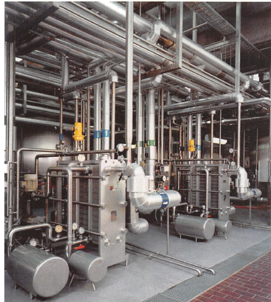
To højtrykspasteuriseringslinier, hver for 18000 liter øl pr. time.
