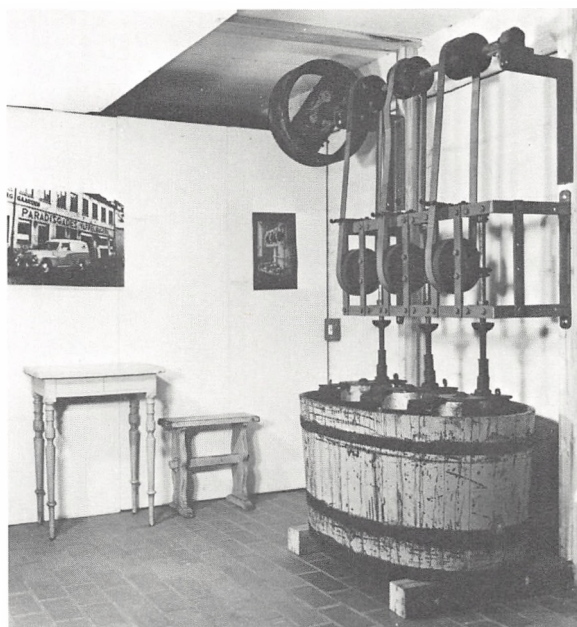
Frysemaskine nr. 2 fra 1930'erne fotograferet på Købstadmuseet »Den gamle By«s udstilling om Paradisgades Vaffelbageri i maj 1980. Remtrækket drejede de 3 isbøtter rundt, medens »omrørings-risene« i bøtterne stod stille. På billedet ses også et bord og en taburet fra vaffelbageriet. (Foto i Den gamle By).
