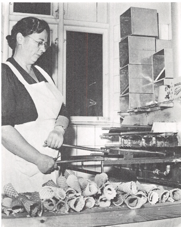
Fru Gerda Rosenlund Nielsen (født 1906), der var gift med den sidste ejer af isbutikken, ved vaffelovnen i 1968, kort før lukningen. Den gasopvarmede ovn var indrettet med 3 jern i nederste og 2 jern i øverste række. I forgrunden ligger de friskbagte vaffler. Det var muligt at bage 350 stk. pr. time, hvis man var rap. (Foto i Den gamle By).
