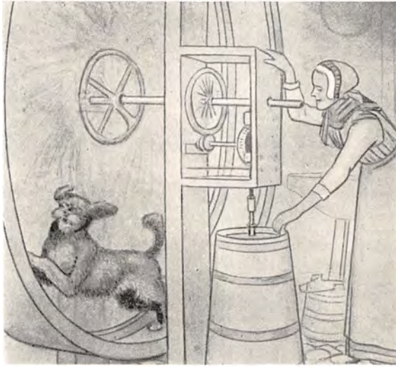
Tilvenstre: Hundekærning. R. Christiansen, Landbrugsmuseet. — Tilhøjre: Slibestenskærne. Landbrugsmuseet. Forskellige Kærner fra før Fællesmejeriernes Tid. Mest almindelig paa jævne Bøndergaarde og i Husmandshjem var Haandkærnen (Stampekærnen); men der findes mange Typer af Kærner med Haandsving. Hundekærnen var derimod nok sjælden
