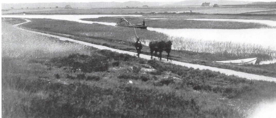
Figur 7. På billedet ses en pram, der trukket af heste, er på vej op ad Gudenåen mod Silkeborg. En tur fra Randers til Silkeborg og tilbage tog typisk en uges tid, nemlig 3 dage til opfarten, to til nedfarten og to til at losse og laste i. På det første stykke fra Randers blev prammene trukket af daglejere, men fra Bjerringbro blev strømmen så stærk, at der måtte heste til. På nedturen gik det lettere, da kunne man flyde med strømmen og stage sig frem (Foto: Lokalhistorisk Arkiv, Silkeborg).
