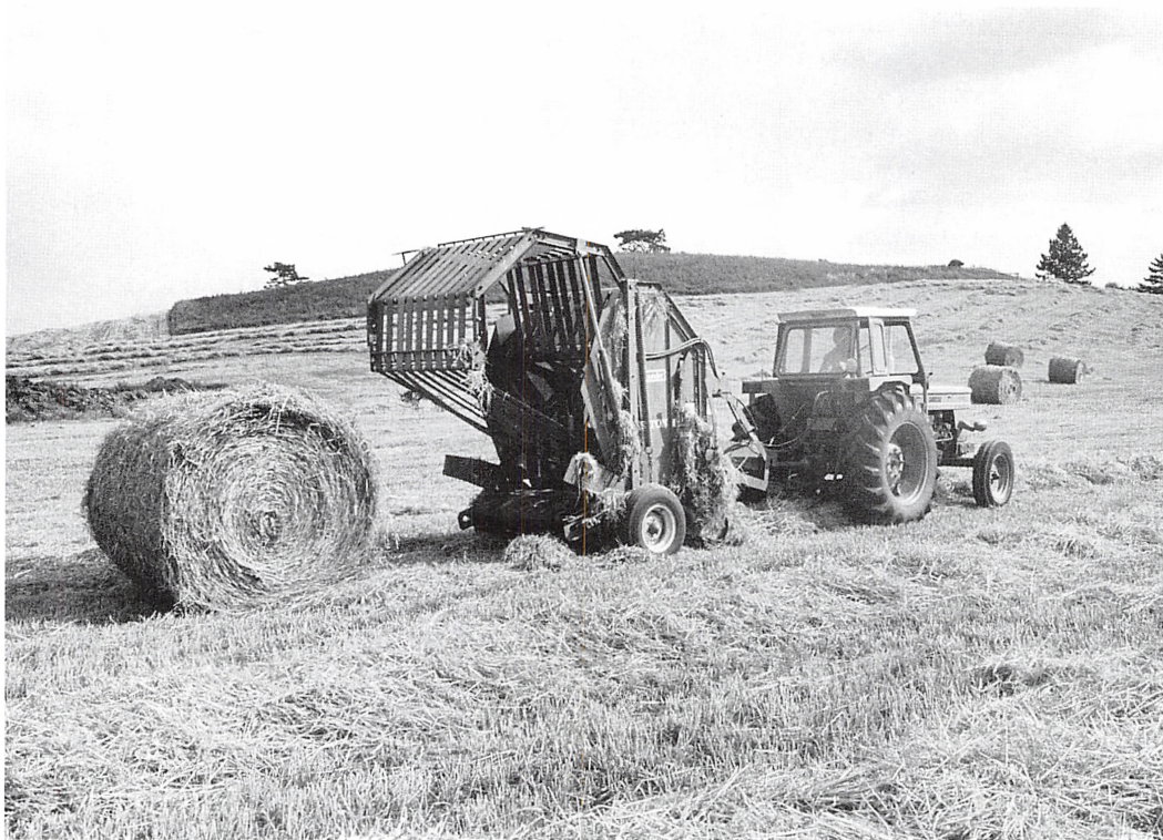
Rundballepresser blev efterhånden den mest almindelige. Den „ruller“ halmen sammen i baller på ca. 300 kg. Foto: Bror Bernild.
