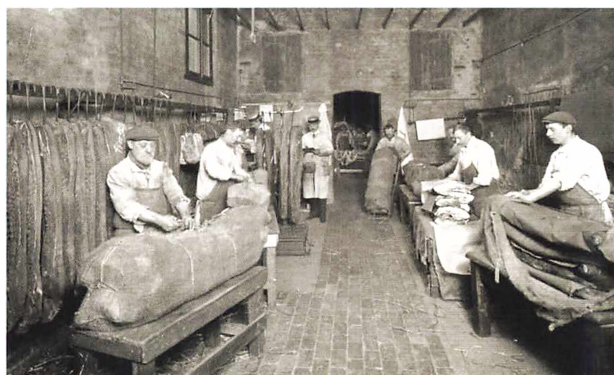
Baconsiderne er nu klar til balningen: Horsens Andelssvineslagteri ca. 1910: Her pakkes i Wrappers af sækkelærred. Wrappers har siden starten på den danske eksport af baconsider været standardballagen. Som det ses på billedet, blev siderne først dækket af papir og derefter indsyet i store lærredstykker. Da sækkelærred var et løst klæde, var baconsiderne udsat for tilsmudsning under forsendelsen. Denne forsendelsesform blev anvendt frem til 1960'erne, hvor man startede på forsendelse af baconsiderne i containere. Foto: Dansk Landbrugsmuseum, Gl. Estrup.
