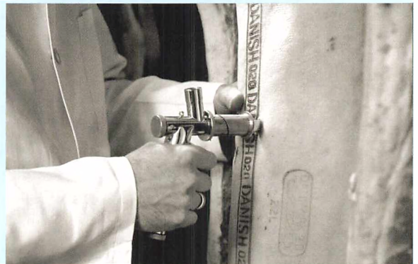
Klassificering – spækkikkert måler spækkets tykkelse ca. 1960. Fremgangsmåden ved tilvirkning af de saltede baconsider – den såkaldte Wiltshire bacon, var i Danmark nøje fastlagt i Landbrugsministeriets baconregulativ. Vejning på slagterierne foregik under opsyn af baconkontrollen, hvorefter klassificeringen fandt sted. Foto: Dansk Landbrugsmuseum, Gl. Estrup.
