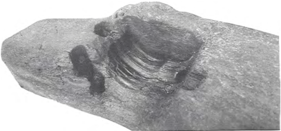
Fig.5. På dette nærbillede af lejebukken kan man se akslens slid på lejet.
