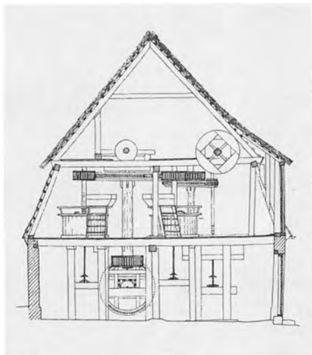
Anders Jespersens rekonstruktionsforslag til Nordre Mølle 1967 (fra siden og ovenfra). Der er regnet med kun ét stjernehjul til at drive de to kværne og forløberen til skalkværnen.
