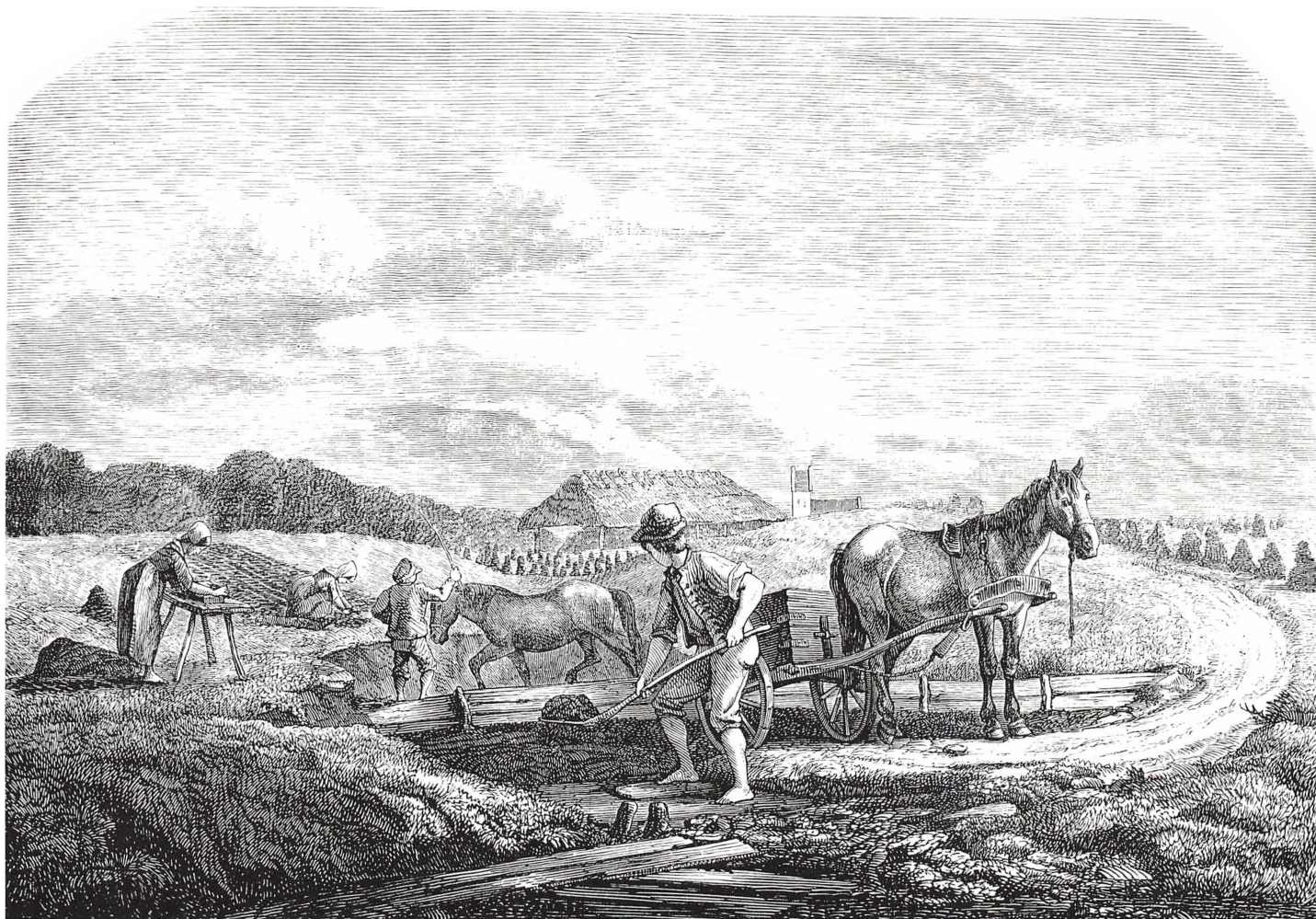
Tørvetilvirkning kunne nok give ømme rygge. Tørvemassen skulle tages op af mosen, og derefter skæres og æltes, formes og udlægges til tørring på jorden. Træsnit fra Illustreret Tidende.
