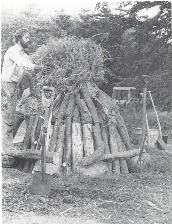
Arbejdet i en studiekreds om lokalhistorien i Mårum og omegn mundede i juli 1983 ud i svidningen af to kulmiler ved Duemose i Gribskov. Her er milen stablet og ved at blive beklædt med halm. (Foto: Birthe Skovholm).
