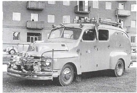
Diamond-førstehjælpsprøjten fra 1951. Vognen havde en 1500 liter/min. pumpe og en 400 liter vandtank samt en vandfyldt førstehjælpslange med tågerør. Den kunne tilsluttes en brandhane, men medførte ikke sugeslange og havde kun et lille skumanlæg. I 1953 blev vognen forsynet med en særlig højtrykspumpe. Byhistorisk Samling
