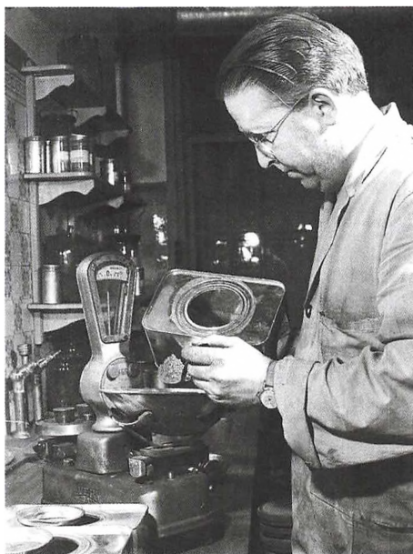
Afvejning af de pulveriserede metaller ved blandingen i Dansk Hårdmetal. Inger Lauritzen.
