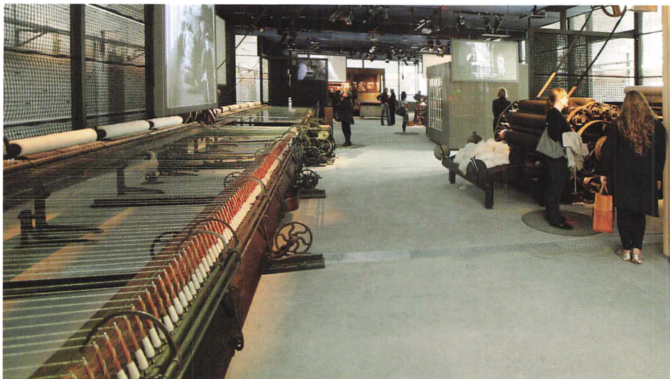
De to maskiner fra Løgstør Klædefabrik genopstillet i Nationalmuseets udstilling Brede Værk. Til venstre den 20 meter lange spindemaskine med sine 300 spindler, til højre i baggrunden kartemaskinen. John Lee foto, Nationalmuseet.
