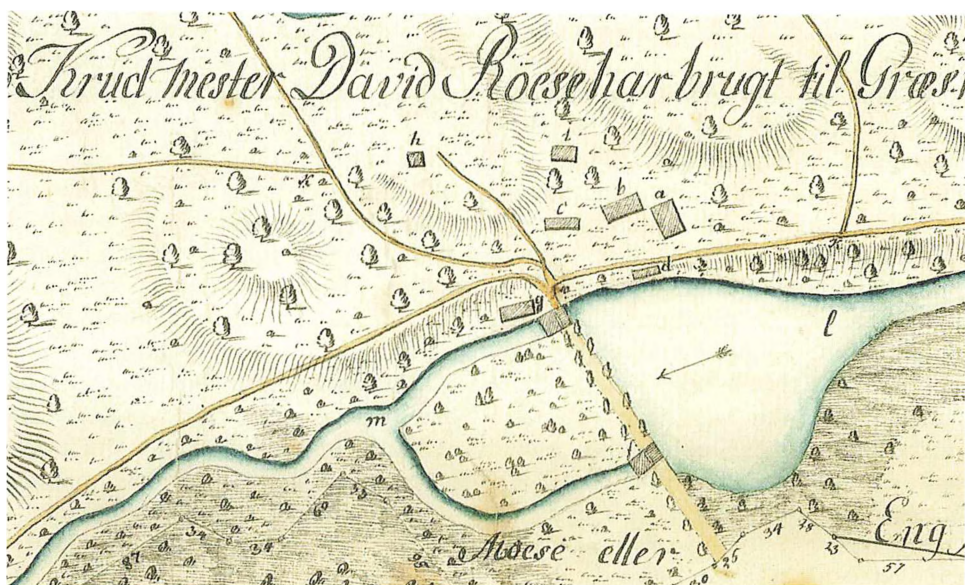
Udsnit af kort over Raadvad i 1758 med krudtværkets bygninger. a er stuehuset, b stald, c vognskur, d drøgstuen (tørrehus), e (ses ikke på kortet, men er bygningen lige under »g«) melmøllen, f den gamle krudtmølle, g den nye krudtmølle, h salpeterhuset (lutningshus), i kørnehuset. (Rigsarkivet ... Råd vad krudtmølle).
