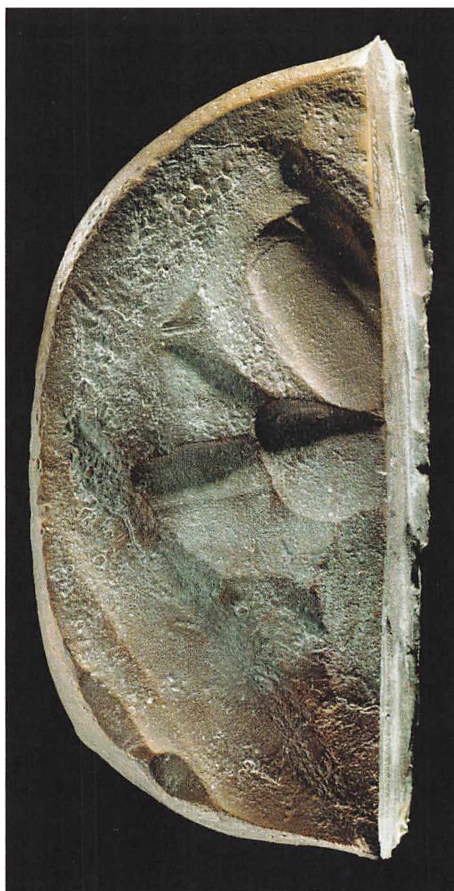
Et hartstykke efter at det er blevet delt under hammeren. Stykket er fundet ved Nymølle, der var kobberværk frem til 1794.
