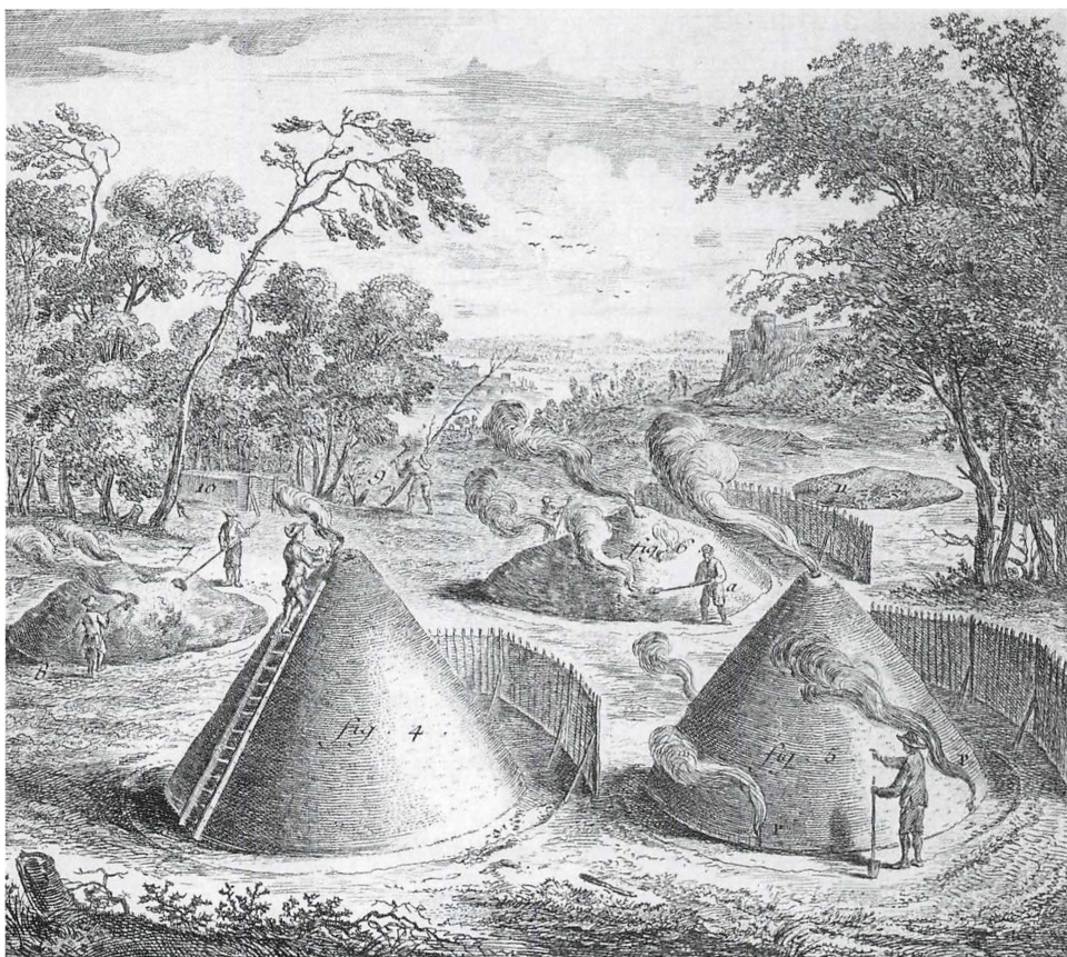
Fremstilling af trækul i miler, d.v.s. træ stablet som en kegle og dækket af et lag af jord og græstørv. Til venstre antændes milen, og til højre reguleres forbrændingen med ventiler i bunden. Efter et stykke tid lukkes alle huller, hvorved træet forkuller i stedet for at brænde. (Denis Diderot (red.): Encyclopédie ou Dictionnaire raisonné des sciences, des arts et des metiers, Planches, tome I, Oeconomie rustique, Charbon de bois, planche II, Paris 1762. Det Kongelige Bibliotek. )
