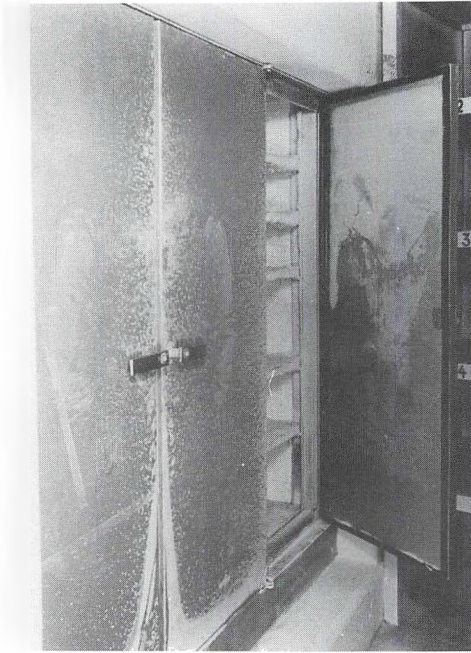
Eksempel på kontakt-fryseskab. Lynfryser \pm 25-30^{\circ} Celcius.
