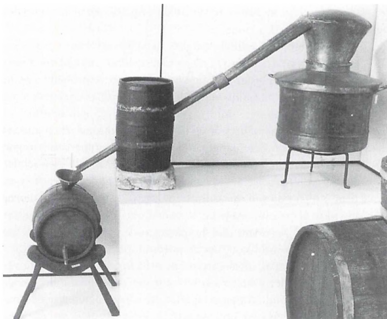
Brændevinstøj bestående af kedel, piber, svaler og opsamlingsanker. Dansk Landbrugsmuseum, Gl. Estrup fot.
