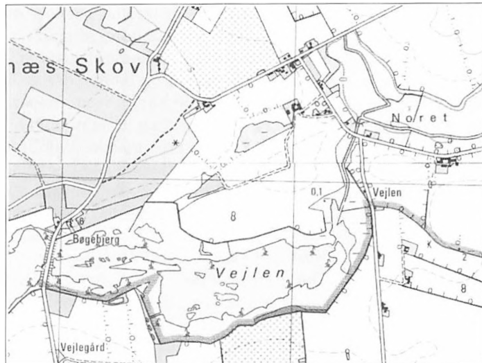
Fig. 4 viser Vejlen og Noret på Tåsinge. Vejlen og Noret er et eksempel på en inddæmning, som ikke pumpes, hvor vandstanden reguleres vha. en sluse. Vejlen (54 ha) og Noret (14 ha) blev inddæmmede i 1765 af kammerherre Niels Juul. Udsnit af kort 1311 INV & 1312 II SV, 1:25.000, rettet 1996. Copyright Kort & Matrikelstyrelsen.
