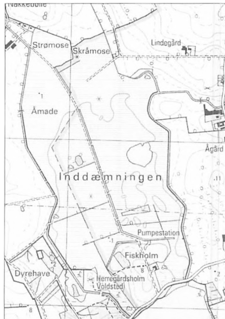
Fig. 2 viser Nakkebølle inddæmningen på Sydfyn. Inddæmningen er omgivet af ringkanaler, der løber lige over kote 0 og bortleder oplandets afstrømning alene med sluser. Fjordens tørlægning blev foretaget i 1866. Arealet under 0 udgør 62 ha. I øjeblikket udføres naturgenopretning på arealet. Udsnit af kort 1312 III SØ, 1:25.000, rettet 1996. Copyright Kort & Matrikelstyrelsen, Rentemestervej 8, 2400 København NV.
