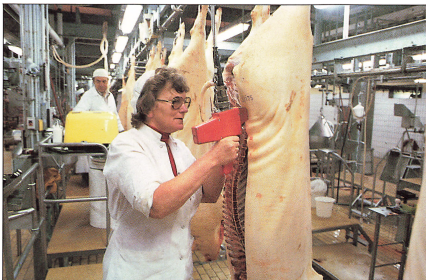
EDB og automatik i det moderne slagteri. Ved hjælp af KSA-måleren sker der af-regning til leverandøren i forhold til kvalitet direkte ved slagteprocessen.
