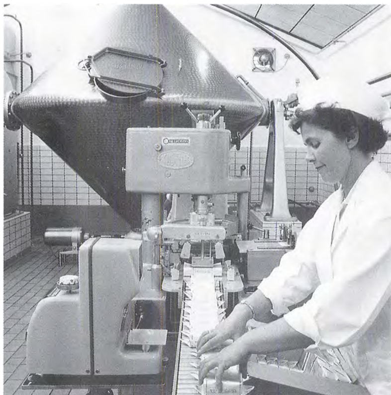
I 1950'erne gik man over til at emballere smørret i lurmærkede pakninger i stedet for dritler. Billedet er fra et smørpakeri i Sønderjylland.
