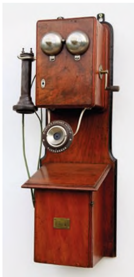
Fig. 3. Telefon produceret af Ferd. E. Sørensen omkring 1886. I mikrofonens rundkreds ses: "Ferdin. E. Sørensen. Patent. Kjøbenhavn". (Post & Tele Museum Danmark).
