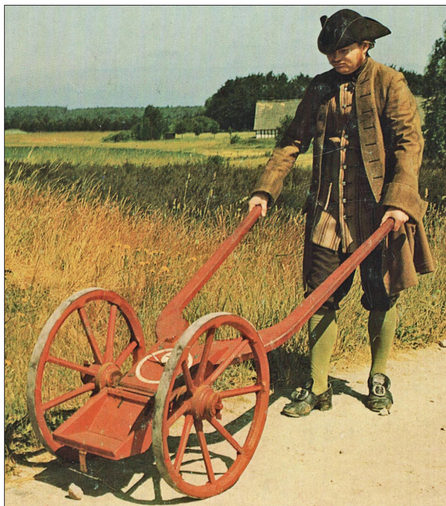
Fig. 5. En såkaldt milevogn til opmåling af afstande. Man ved, at Christian IV allerede omkring 1630 rådede over et lignende udstyr. Det er ikke utænkeligt, at Johannes Mejer har haft det til disposition ved sin kortlægning i 1640'erne. Det vides dog ikke, idet han var meget hemmelighedsfuld om sin fremgangsmåde ved opmåling. Gengivet efter: Erling Pade, Milevognen, Privattryk 1976.
