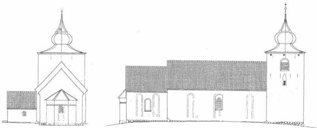
Fig. 1. Ølsted kirkes frådstensmure har rester af en særegen vinduesindfatning med rundbuede blændinger, der er ført helt ned til soklen. Våbenhus og tårn er sengotiske tilbygninger. Facade mod øst (til venstre) og nord. Tegning ved arkitekterne Birch & Svenning 1991.
