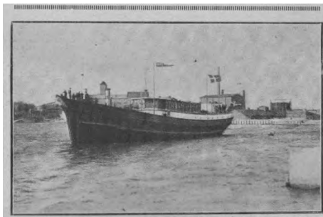
Den nye Grønlandsdamp Gertraud Rask , opkaldt efter Hans Egedes Hustru, løber af Stabelen paa Nakkov Skipsværft. Den nye Damp er af Hensyn til Iskrængerne bygget næsten helt af dansk Egetræ, og den er paa 800 Tons. Den skal rigges som firemastet Skonnert, men faar dog ogsaa en Dampmaskine paa 350 Hestekræfter. Det er med denne Damp, at Rigsdagsmedlemmerne skal gøre Grønlandsturen i Sommer. Det er et smukt Stykke dansk Arbejde, som Værftet i Nakkov har Ære af.
