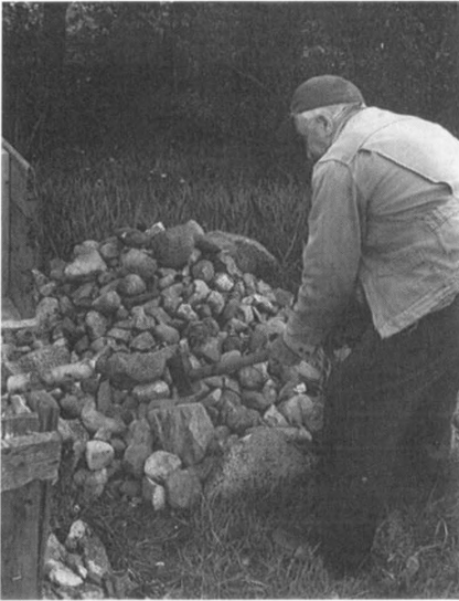
De store sten i dyngen slækkes med spaltehammeren – på jysk kaldet »æ spaltehammer« – inden de kan videreforarbejdes på ambolten. (Foto: Børge Gade)
