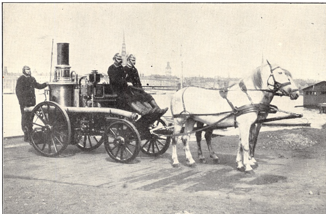
Fig. 8. Dampsprøjtetype fra Ludwigsbergs Werkstads A. B. Stockholm.
