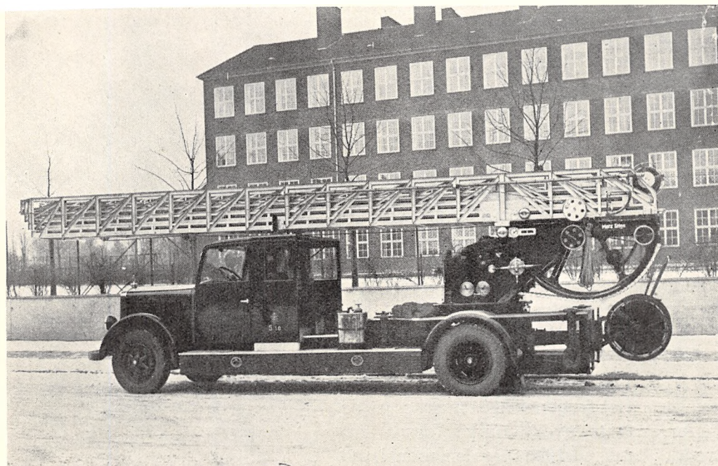
Fig. 57 a. Københavns Brandvæsens Taarnstige Model 1934, Højde 30 m, leveret af Metz, Karlsruhe.
