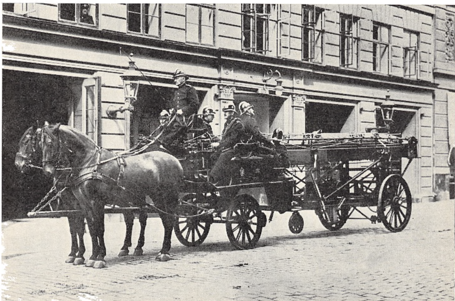
Fig. 30 a. Københavns Brandvæsens 20,5 m Balancestige Model 1907.
