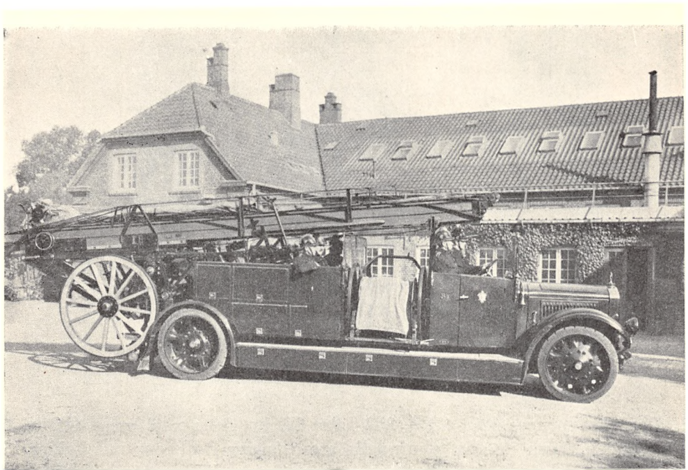
Fig. 36. En af Københavns Brandvæsens 22 m Afprotstiger Model 1930. Stigen paaprotset.
