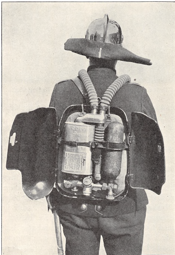
Fig. 51 b. Kredsløbapparat Model Dräger K. G. 1928. aabnet.
