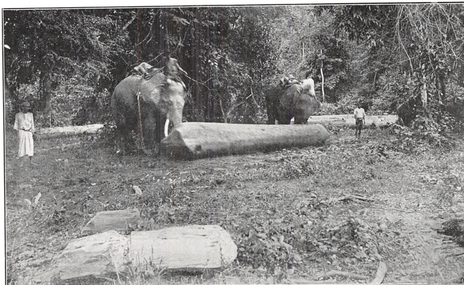
Fra Voksestedet slæbes Teakstammerne af Elefanter eller Bøfler — ofte flere Mil — gennem Skoven til Flodløbet og stødes af Elefanter ved Hjælp af Snabelen og Stødtænderne ud i Floden eller det udtørrede Flodleje
