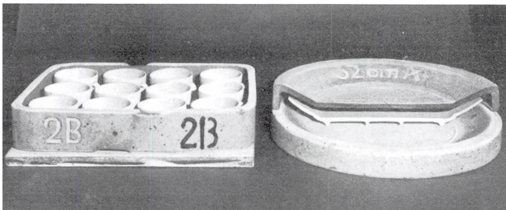
Fig. 10. Karborundum-Specialkapsler. Tilvenstre Kapsel bestående af Plade og løs Ring. Tilhøjre: Kapsel til den viste, samt to andre Typer runde 32 cm Fade.
