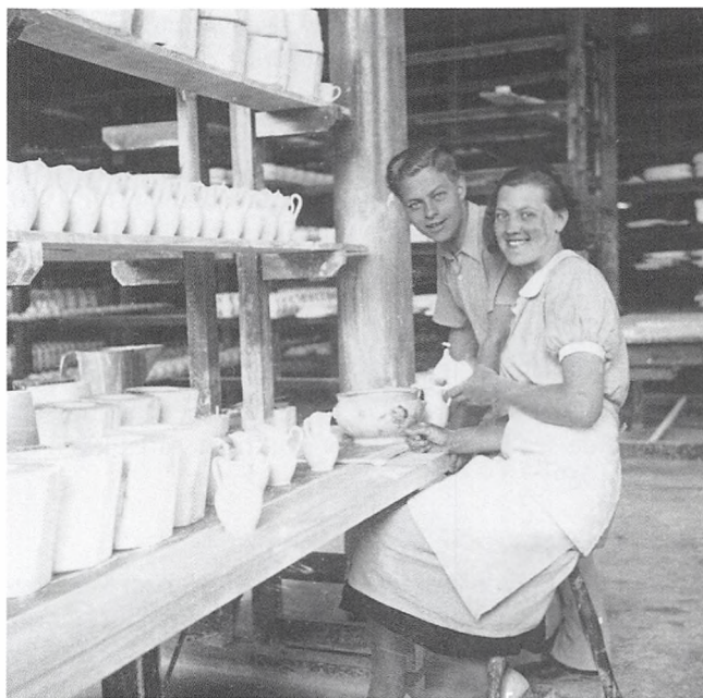
Drejer Jørgen Balsløv besøger støberiet, hvor en støber er ved at garnere flødekander med hank og pudse dem af. I forgrunden ses støbeformene, i baggrunden ses en støbekande. 1938-1943. Byhistorisk Samling
