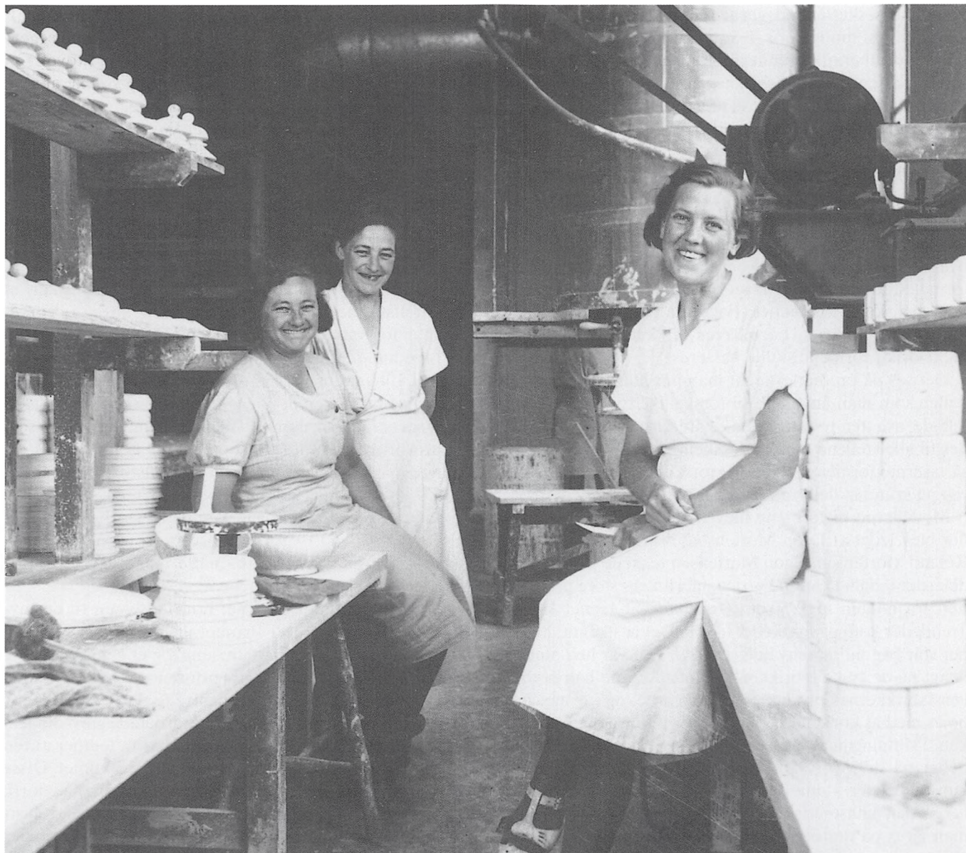
Støberne poserer foran den høje beholder til støbemasse, slikkerkarret. Fra masseøllen i stueetagen blev der pumpet flydende støbemasse op i denne tønde med omrøringsfunktion. Derfra kunne man tappe støbemassen på kander, og hælde den ned i formene. De var indvendigt udformet som det, der skulle støbes. Når der var hældt slikker i formen, stod den og »trak skærv«, til formen havde suget så meget vand til sig, at porcelænet var læderagtigt og kunne tages ud af formen. På hylden øverst ses låg til Vallø sukkerskåle. Foto Jørgen Balsløv 1938-1943. Byhistorisk Samling
