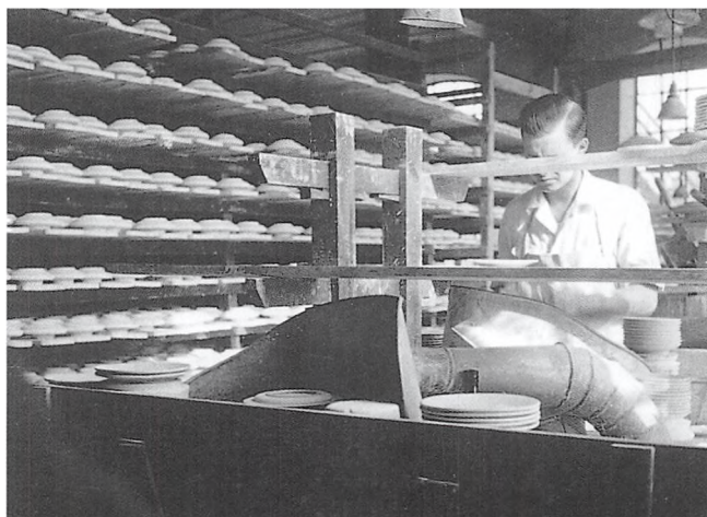
Fabrikken i Lyngby havde udsugning ved de støvende arbejdsfunktioner. Her ser man skærmen med udsugning der, hvor man »drejede af«, dvs. pudsede de halvtørre tallerkner pænt glatte og regelmæssige i kanterne. Drejer Henrik Fessel ses på den anden side. Foto Jørgen Balsløv, 1938-1943. Byhistorisk Samling
