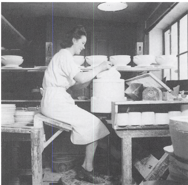
En Vallø terrin er ved at blive pudset af på foden. Emnet står på en ca-valet, drejeskive, der bevæges med fødderne. Støbereren har stablet forme op på den, så hun har en passende arbejdhøjde. Til højre ses udsgningstragten, der skulle tage støvet. Foto Jørgen Balsløv 1938-1943.
