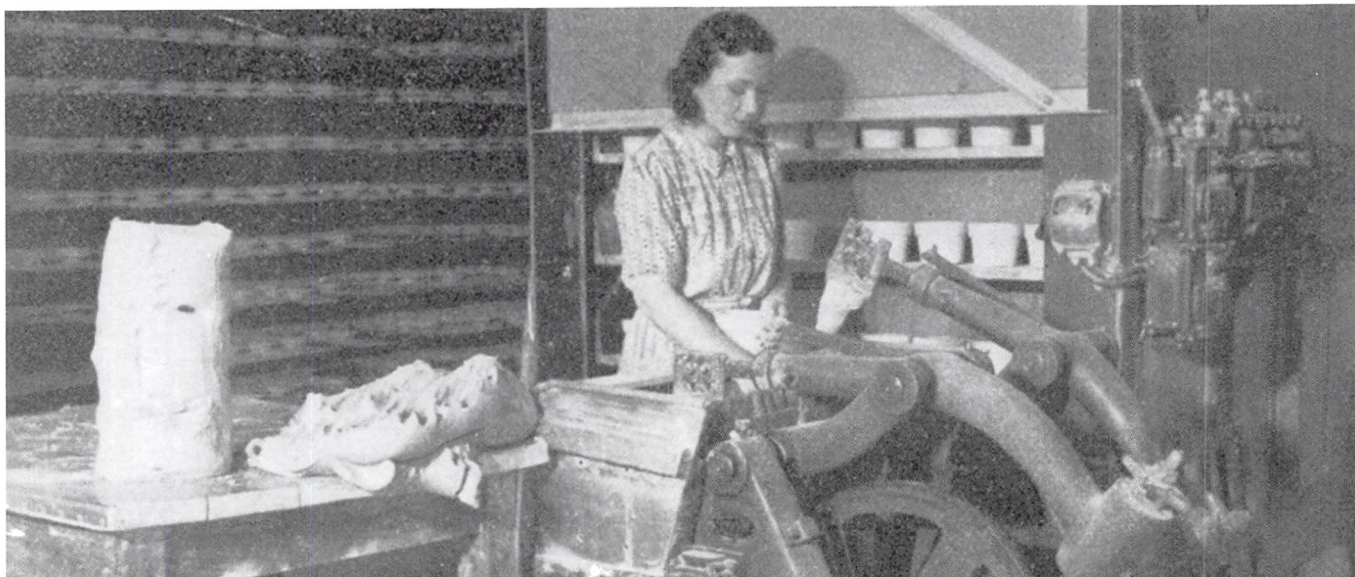
Fig. 5. Automatisk Kopdrejning. Maskinen har to Arme, som bevæges automatisk op og ned, og som bærer Skabeloner. Det manuelle Arbejde indskrænkes derfor til at anbringe en Klump Masse i Gipsformen og sætte denne paa Plads, samt til efter Udformningen af Koppen, at anbringe Gipsformen paa hylden i det automatiske Tørreskab, som ses tilhøre i Baggrunden af Billedet.
