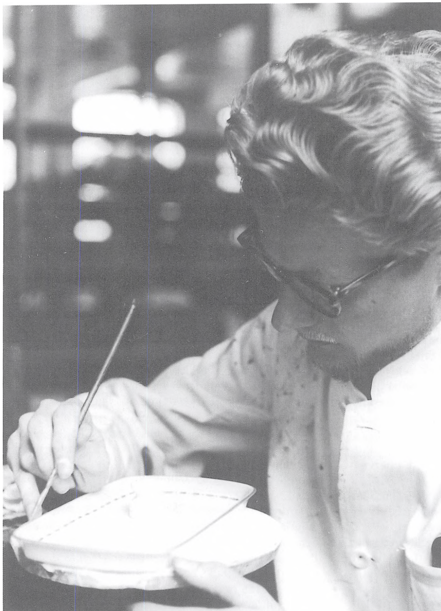
Flemming Gudmark Sørensen maler guldkant på et kagefad i Rebild stellet. De gyldne kviste længe inde på fadet er rullet på med et gummistempel i trykkerstuen. 1950'erne. Byhistorisk Samling
