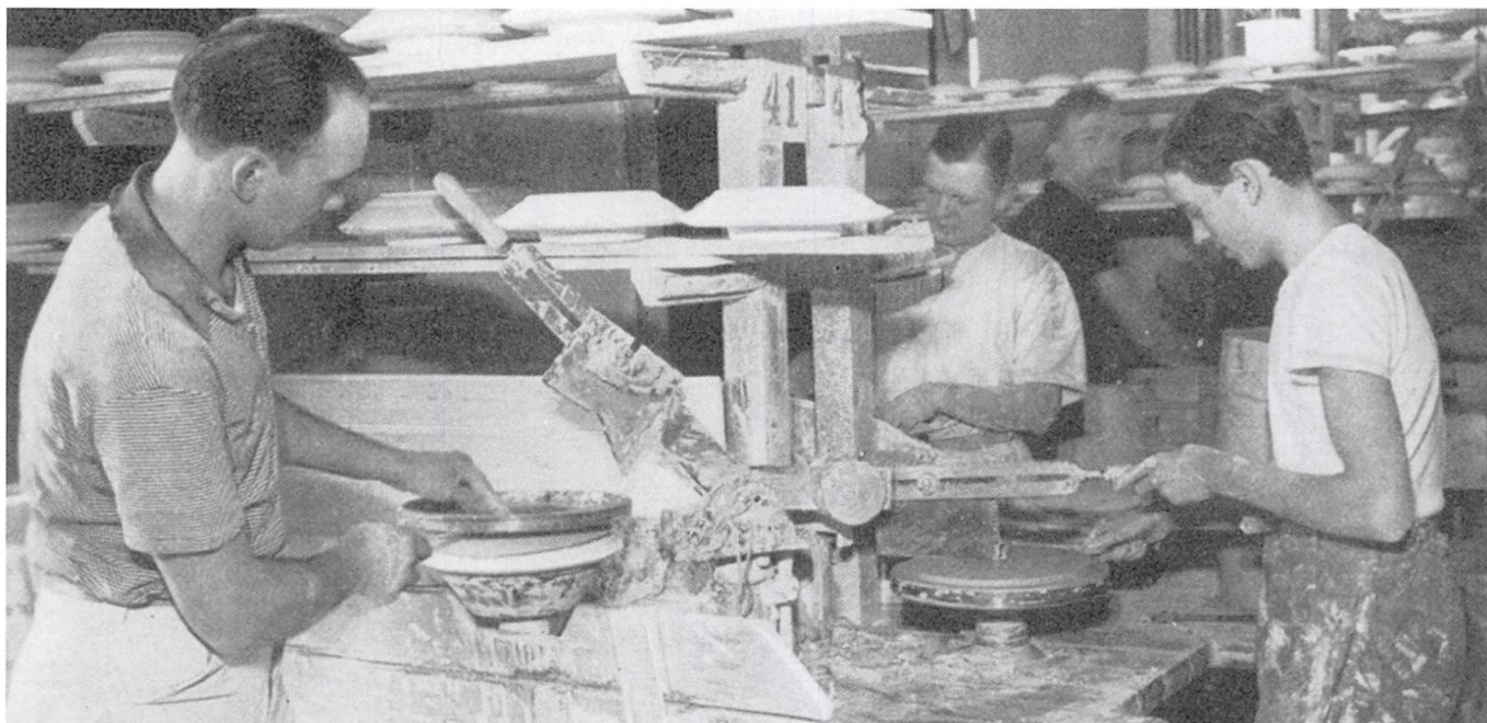
Fig. 4. Tallerkendrejning (almindelig). Drengen tilhøjre er ved at forme en rund Masseplade paa en Skive. Drengen tilvenstre er ved at overføre en Masseplade fra Skive til en Gipsform for derpaa ved Hjælp af Skabelonen, som ses paa den bevægelige Arm over Gipsformen, at udforme Bagsiden af Tallerkenen.
