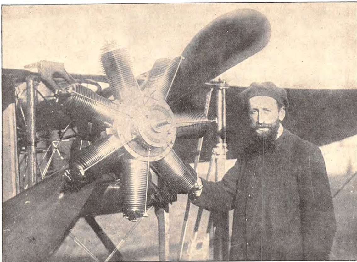
Luftskibsmotor af den svære Type, som fandtes paa Delagrangés Monoplan.
