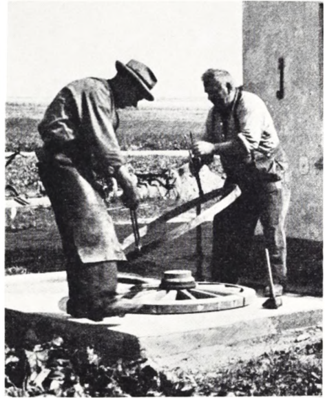
Fig. 4. Smedemester Fr. Helt. Sædder, og hans broder ringer et vognhjul uden for smedjen.
