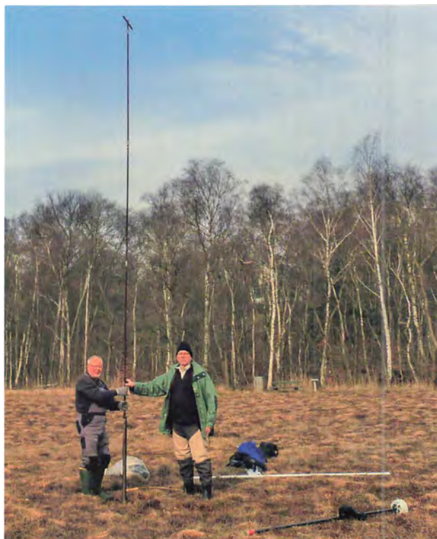
Fig. 2. Fra arbejdet med undersøgelse af tørvelagene i Lyngby Åmose ved boring i 'Højmosen' den 17. marts 2015. Boret er i alt 6 m langt og består af borehoved og forlængerstænger.
