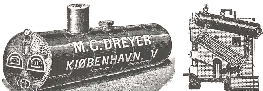
T.v. en Lancashire kedel fra 1889, t.h. en vandrørskedel fra 1895. Begge fra M. C. Dreyers Maskinfabrik og Kedelsmedje i København. En Lancashire kedel arbejdede efter samme princip som en cornisk kedel, men havde to indfyringskanaler. Begge kedler var fremstillet af stålplader.
