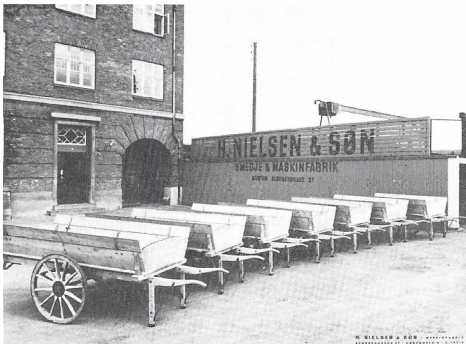
Lo-tech vognsmedarbejde anno 1942. De syv trækvogne til postvæsenet var nu ikke fuldkomment primitive. De var specialaffjedrede, for at skåne pakkerne.
