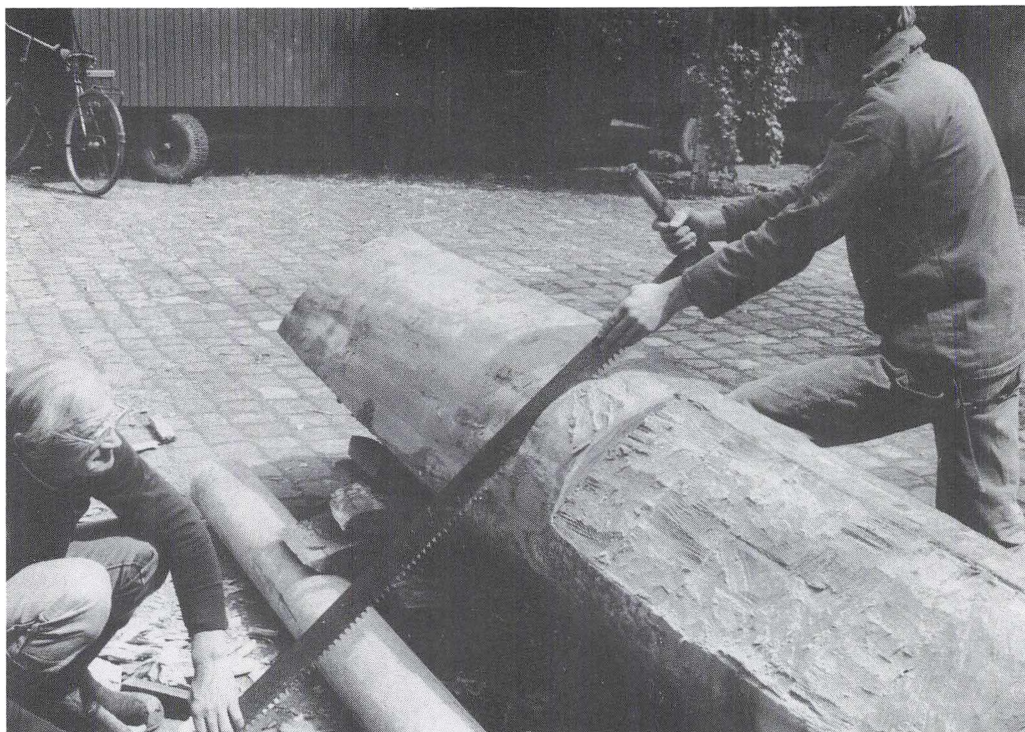
Fig. 2. Museet Falsters Minder rekonstruerede i 1988 en Hasselø-ege. Skovtekniker Poul Erik Petersen og hjælper er her ved at save en stopkærv, inden træet spaltes væk med kiler.
