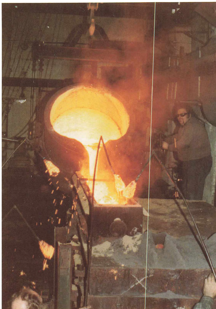
Fabrikken var især støberi og her ses en motorblok under støbning. Vægt ca. 2000 kg. temperatur 1400 grader.
