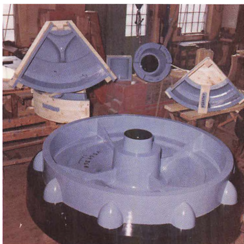
Model for kabelarskive (kædehjul).
