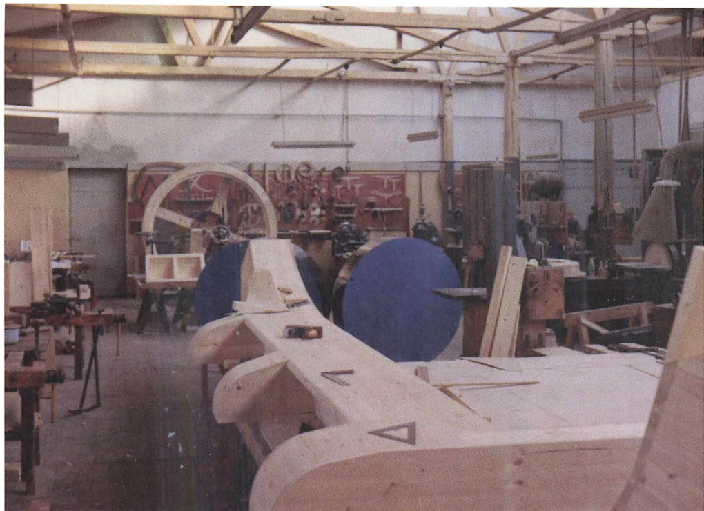
Model for agterstavn med rorløkker, skulle støbes i stål på Varde Stålværk for Nakskov Skibsværft.
