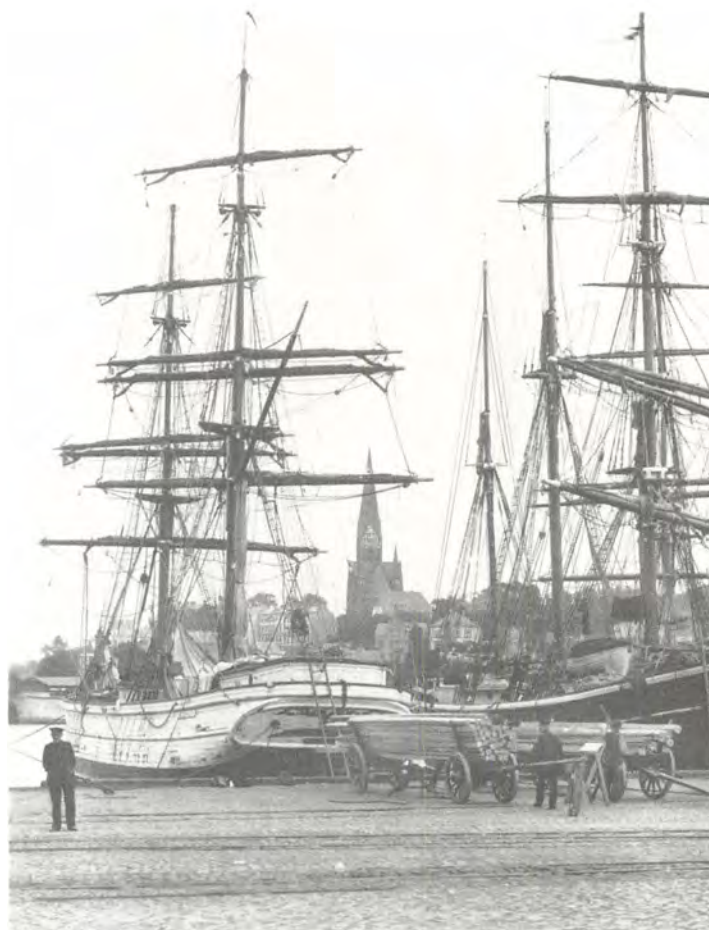
Foto af brig i Flensborg havn omkring 1860. En brig er et stort tomastet og fuldrigget skib med mange ræer. Der losses tømmer. Det videre forløb kender vi ikke, men der var gode indtægtsmuligheder derefter ved at laste "Flensborgsten" til Dansk Vestindien og sejle hjem med sukker til romfabrikkerne.
