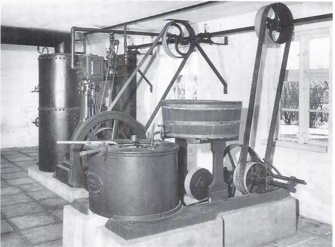
På mejerimuseet i Hjedding ses (forrest i billedet) en centrifuge drevet af en lodret stående dampmaskine.
