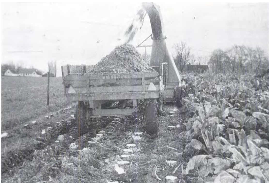
Moderne roehøstningsteknikker gør det muligt at afhugge, findele og videretransportere materiale, så det kan placeres i en ensilagebeholder. Bagefter bliver roerne taget op af en særlig maskine.
