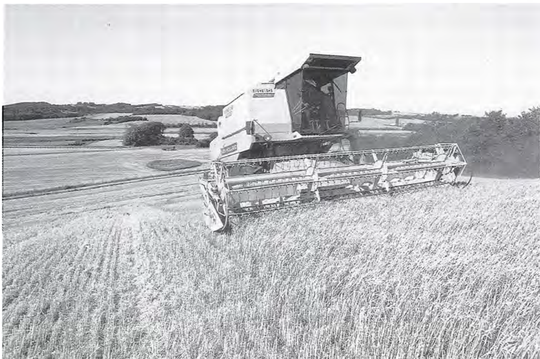
Mejetærsker i arbejde. I perioden 1950–70 overtog en maskine af denne type såvel høst- som tærskningsarbejde i dansk landbrug.
