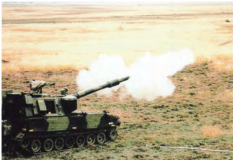
155 mm selvkørende haubits M1109 blev modtaget i 1965 og ses her under skudafgivelse. Pjecen indgår fortsat i hærens artilleri efter en række moderniseringer bl.a. forlængelse af røret og dermed forøget skudvidde. (Hærens Artilleriskole)
