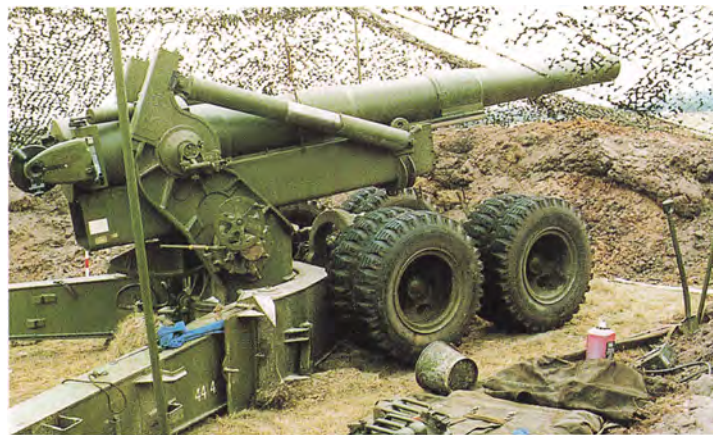
I 1955 fik feltartilleriet sin hidtil største pjec i form af 203 mm haubits M155. Denne pjec kunne ligesom Nike og Honest John benytte atomammunition, som imidlertid aldrig blev opbevaret i Danmark. Udfasning af pjecen påbegyndtes i 1999. (Hærens Artilleriskole)
